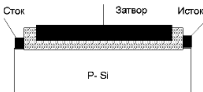
Рис. 2.2. Принципиальная схема устройства полевого транзистора
